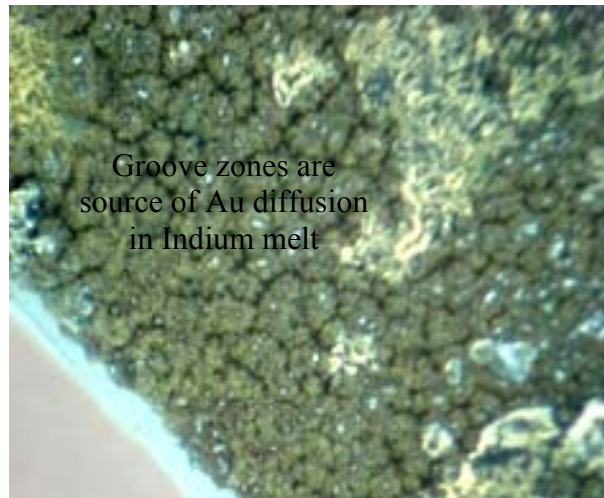
Fig. 2. Groove formations on Au substrate
