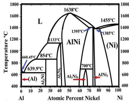
Fig. 14. Ni-Al phase diagram <sup>[24]</sup>.
