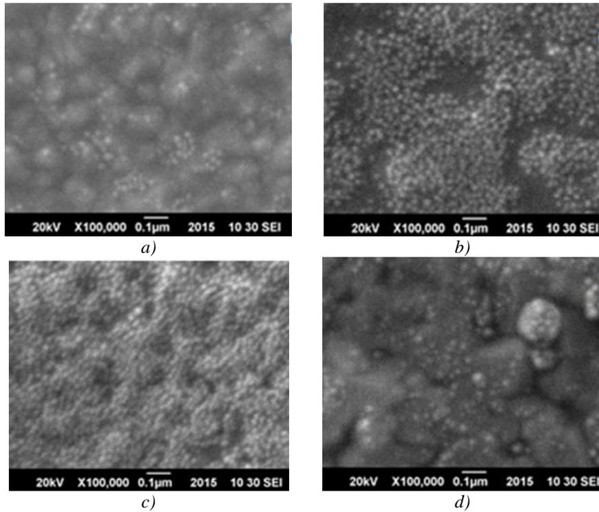
Fig. 2. SEM micrographs of (a) CdZnS 350°C-1h (b) CdZnS 350°C-2h; (c) CdZnS 400°C-1h (d) CdZnS 450°C-1h.
