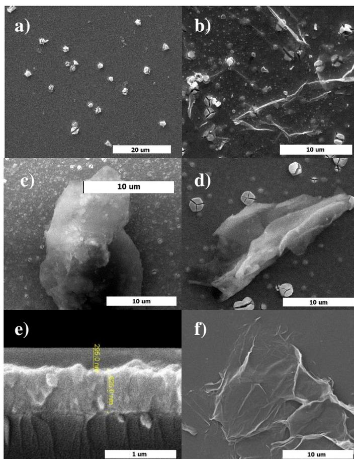
Fig. 2. The SEM images of (a)  $\text{WO}_3/0.8 \text{ wt}\% \text{Ag}_3\text{PO}_4$ , (b)  $\text{WO}_3/0.8 \text{ wt}\% \text{Ag}_3\text{PO}_4/0.01 \text{ wt}\% \text{rGO}$ , (c)  $\text{WO}_3/0.8 \text{ wt}\% \text{Ag}_3\text{PO}_4/0.05 \text{ wt}\% \text{rGO}$ , (d)  $\text{WO}_3/0.8 \text{ wt}\% \text{Ag}_3\text{PO}_4/0.10 \text{ wt}\% \text{rGO}$  (e) a cross-section of the  $\text{WO}_3/0.8 \text{ wt}\% \text{Ag}_3\text{PO}_4$  films and rGO sheet.
