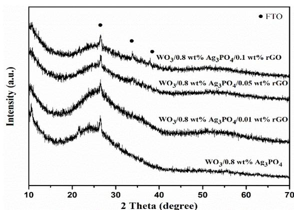
Fig. 1. The x-ray diffraction patterns of (a)  $\text{WO}_3/0.8 \text{ wt\% Ag}_3\text{PO}_4$ , (b)  $\text{WO}_3/0.8 \text{ wt\% Ag}_3\text{PO}_4/0.01 \text{ wt\% rGO}$ , (c)  $\text{WO}_3/0.8 \text{ wt\% Ag}_3\text{PO}_4/0.05 \text{ wt\% rGO}$  and (d)  $\text{WO}_3/0.8 \text{ wt\% Ag}_3\text{PO}_4/0.10 \text{ wt\% rGO}$  films.
