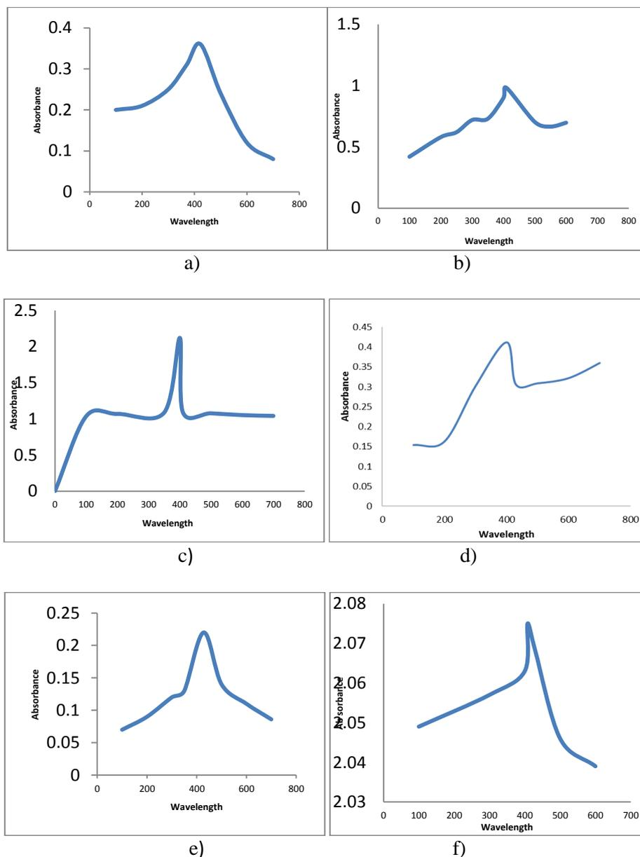
Fig. 2. UV-Vis absorption spectra of silver nanoparticles biosynthesized by: A) *Ulva fasciata* B) *Cystoseira myrica* C) *Gelidium crinale* D) *Laurencia obtuse* E) *Turbinaria turbinata* F) *Corallina elongate*.
