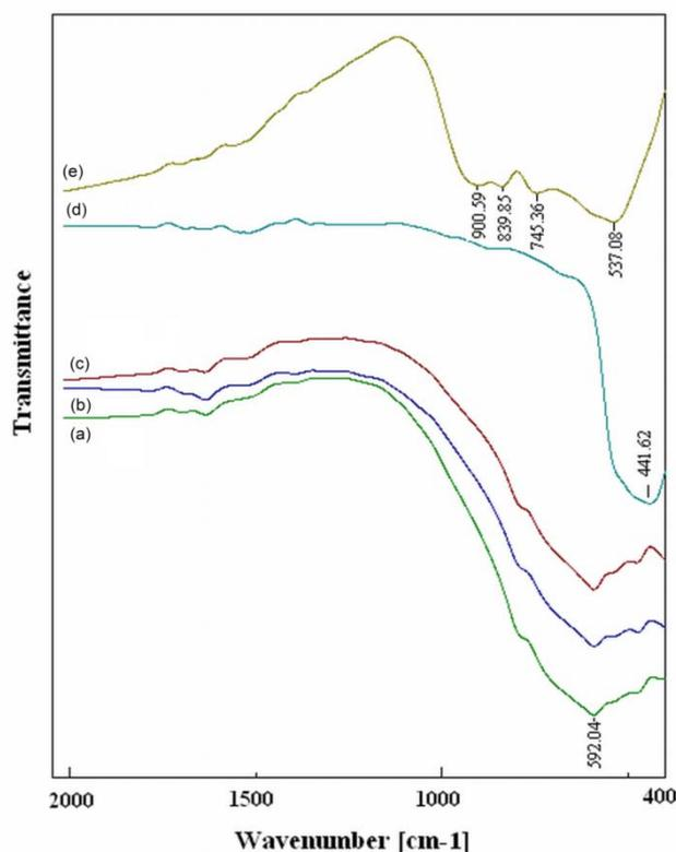
Fig.2. FT/IR spectra of the obtained  $\text{ZnTa}_2\text{O}_6$ : (a)  $\text{pH}=12.5$ ; (b)  $\text{pH}=10.5$ ; (c)  $\text{pH}=7$ ; (d)  $\text{Zn}(\text{NO}_3)_2$ ; (e)  $\text{Ta}_2\text{O}_5$
