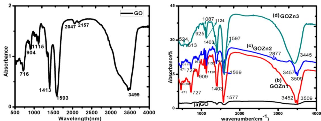
Fig. 4. IR spectroscopy of graphene /ZnO nanocomposites (a) GO (b) GOZn1 (c) GOZn2 (d) GOZn3.
