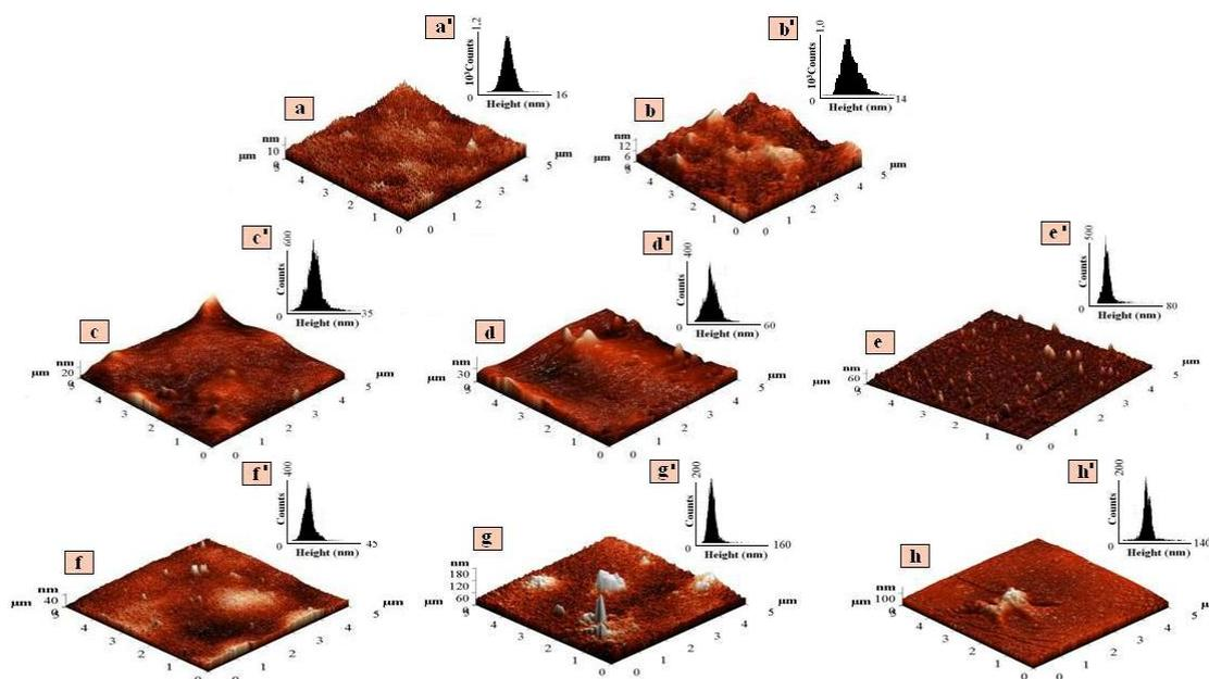
Fig. 2. Tapping mode of AFM images and histograms of a) untreated PET; b) 10 min plasma treatment; c) C10; d) C20; e) C30; f) PC10; g) PC20; h) PC30
