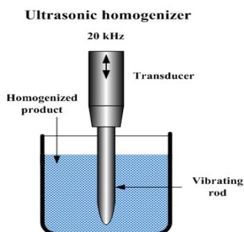
Fig. 10. Ultrasonic Homogeniser.
