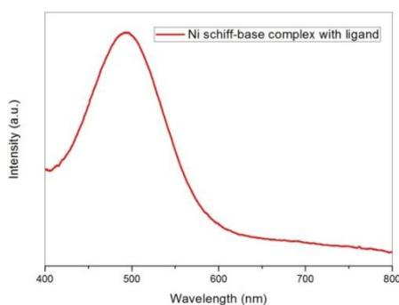
Fig. 6 UV-Vis spectra of Ni Schiff base complex containing 4,4'-methylene bis (2,6-diethyl) aniline-3,5-di-tert-butylsalicylaldehyde ligand
